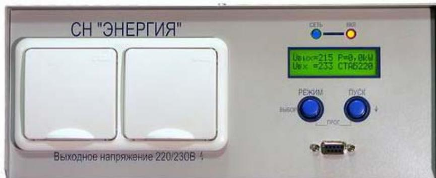
на выходе через внутренние емкости возможно появление напряжения порядка 100В) еще через пару секунд появится стабилизированное напряжение на выходе прибора. Стабилизатор включен и готов к работе.
